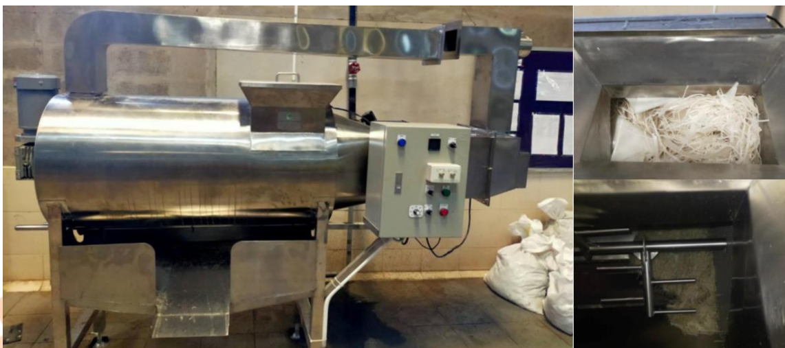
ภาพที่ 4 แสดงเครื่องอบแห้งเส้นก๋วยเตี๋ยวโดยใช้ความร้อนจากไอน้ำเหลือทิ้งที่มาจาก: ปฏิพัทธ์ ถนอมพงษ์ชาติ และคณะ, 2564
