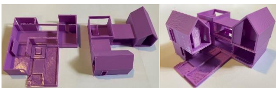
รูปที่ 12 ชิ้นงานจริงที่ใช้พรีนเตอร์ 3 มิติ ขนาด 1:75
