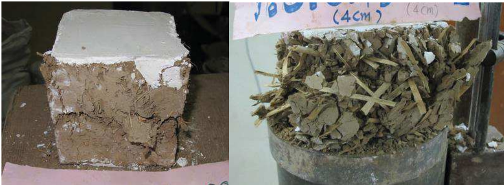
ภาพที่ 12 การวิบัติด้วยพฤติกรรมแบบเหนียวของอิฐดินดิบผสมใบหญ้าแฝกภายใต้แรงอัด
